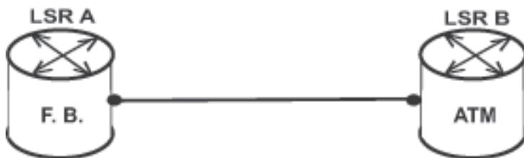
Figura 7.2 Conexão entre *frame-based* LSR e ATM-LSR.
