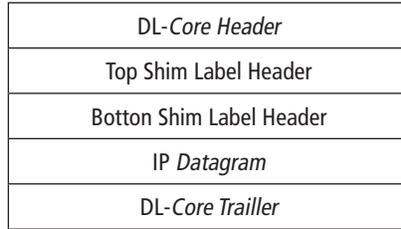
**Figura 7.13** Encapsulamento no MPLS sobre *Frame Relay*.
